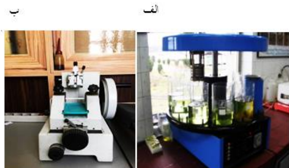
شکل ۳: الف: دستگاه عمل آوری بافت (مراحل شستشو، آبیگری و شفاف‌سازی بافت‌ها) ب: دستگاه میکروتوم (Leitz, 1512) جهت تهیه اسلایدهای بافتی
